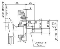
PRESA DI FORZA SU ALBERO A CAMME OPZIONALE CON SENSO DI ROTAZIONE DESTRO OPTIONAL P.T.O. ON CAMSHAFT WITH CLOCKWISE DIRECTION OF
